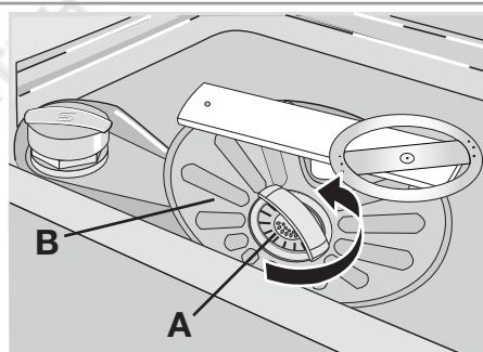
2. Фильтр (A) состоит из двух частей. Для разборки фильтра разъедините эти части.
